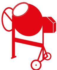
LE BÉTON D'ARGILE SE PRÉPARE EN BÉTONNIÈRE DE 350 LITRES PAR 3 OU 4 SACS (+ GRAVILLONS) À LA FOIS. NE PAS MALAXER PLUS DE 5 MINUTES.
